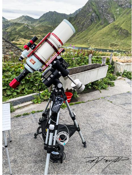
Fig. 2: Tripletto apocromatico, telescopio molto performante con cieli bui, usato per scattare la foto della nebulosa (foto Stefano Falchi).
